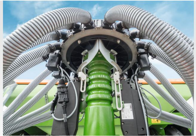
Tête de distribution segmentée avec coupure électrique unilatérale
