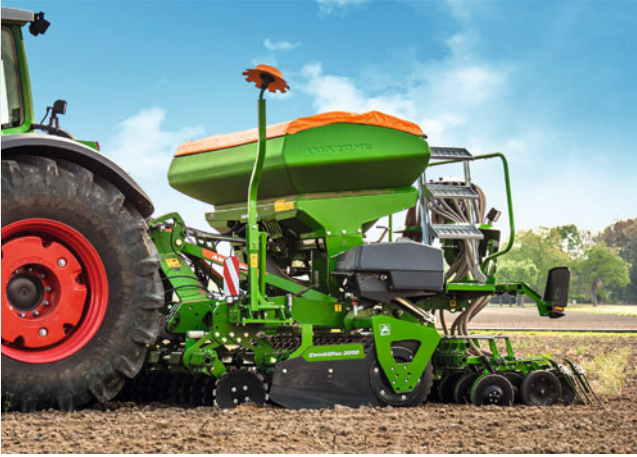
Semoir compact Centaya 3000 Super avec le préparateur de sol à disques indépendants compact CombiDisc 3000
