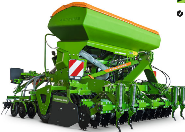
Préparateur de sol à disques indépendants compact CombiDisc 3000 avec le semoir compact Centaya 3000 Super
